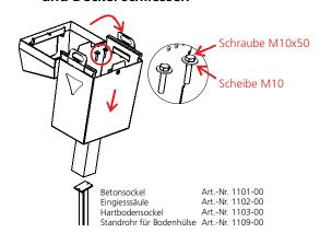
Behälter über Säule stülpen und mit 2 Schrauben M10x50 befestigen. Deckel schliessen
