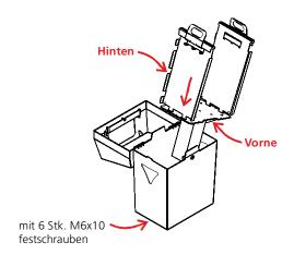
Bodenplatte mit Standrohr umgekehrt einsetzen und von unten befestigen
