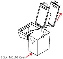
Bodenplatte mit Standrohr lösen und nach oben ausbauen
